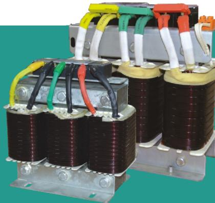
该电抗器专用于智能电容器，电容器受到谐波电流、合闸涌流及操作过程电压的影响，造成电容损坏和功率因数降低，为此需要在电容器前端加装串联电抗器，用以抑制和吸收谐波、保护电容器，避免谐波电压电流及冲击电压电流影响，改善电能质量提高系统功率因数，延长电容器使用寿命。
